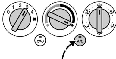
Das Gebläse auf Stufe **3** oder **4**, Temperaturregler ganz auf warm und Luftverteilungsregler auf Position stellen. Die Klimaanlage zur Unterstützung einschalten.
